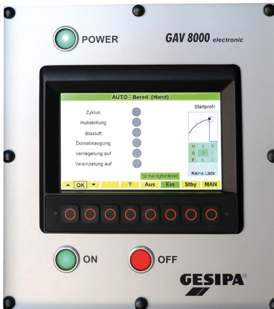
Pantalla de una GAV 8000 electronic con curva de remachado como parte del control de proceso de remachado
