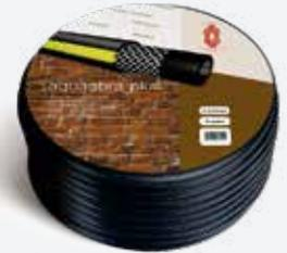
01.-Capa exterior estriada y color negro para facilitar resistencia a agentes atmosféricos y al desgaste. 02.-Capa intermedia: capa refuerzo con malla de hilo de poliéster para dotarla de mayor resistencia. 03.-Capa interior negra de uso alimentario.
