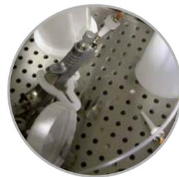
Dispositivos soplado neumáticos para evitar la entrada de disolvente en el interior de la pistola.
