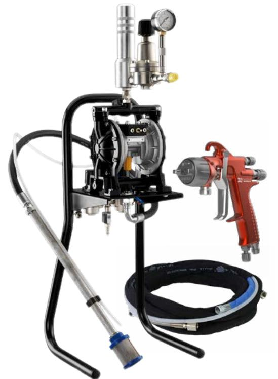
**\*Equipo completo (estándar), incluye DM 1/300 (carro y sonda con regulador), X 4100 series Presión 1.20 (XT01 B) y 5 m. mangueras de aire y producto.**
